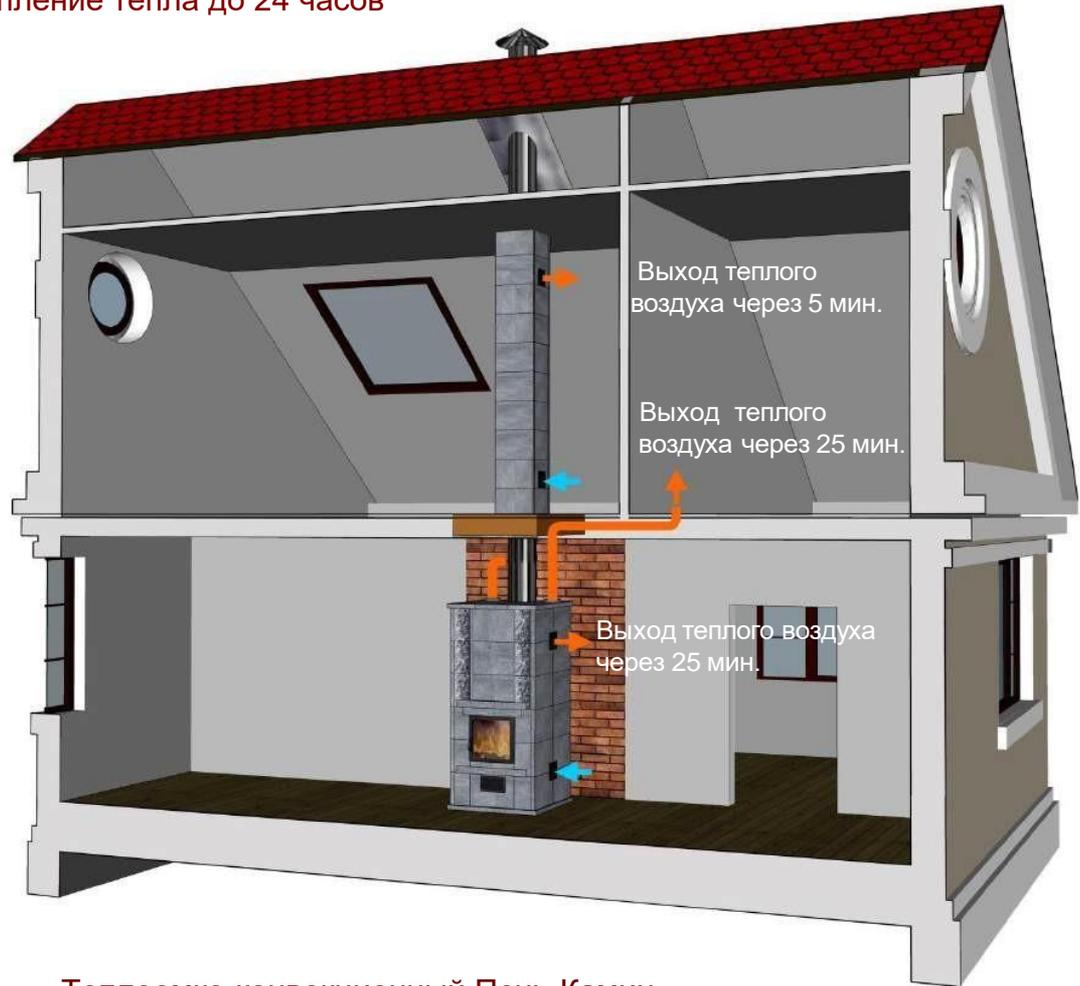
Теплоемко-конвекционный Печь-Камин Sampro накапливают тепло в режиме:
