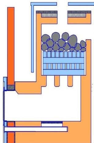
В Печах для Бань по - Серому полностью отсутствует металл в конвекционной зоне и топке
