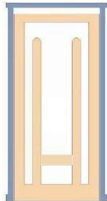
Топка печей SAMPO из шамотных блоков толщиной 90 мм
