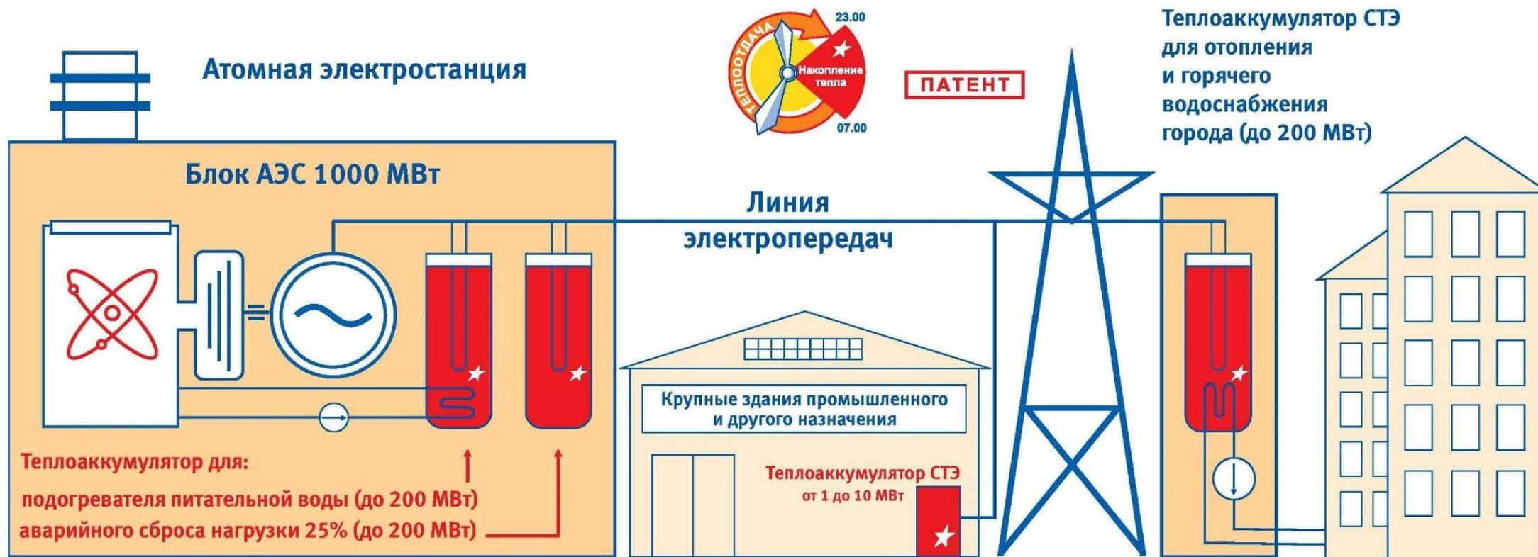
Твердотельные теплоаккумуляторы ТА большой мощности могут использоваться для стабилизации работы атомных электростанций и обогрева городов расположенных в районе 50 км от АЭС
