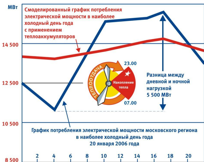
Рис.2 Применение СТЭ высвободит только в г.Москва 2200 МВт электрической мощности
