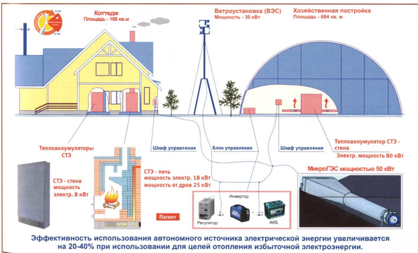
Рис. 8. Энергообеспечение коттеджа и хозяйственной постройки от автономных источников энергии (ВЭС, микроГЭС)
