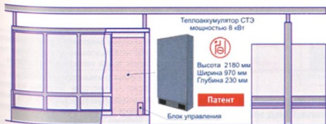
Рис. 4. Применение СТЭ во временных сооружениях
