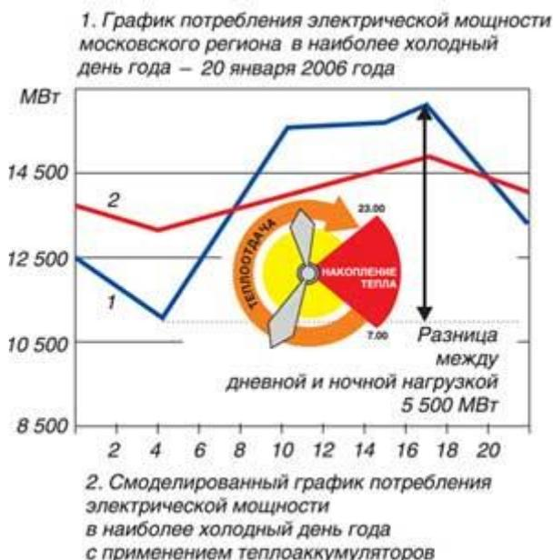
Рис. 2. Применение СТЭ высвободит только в Москве 2 200 МВт электрической мощности
