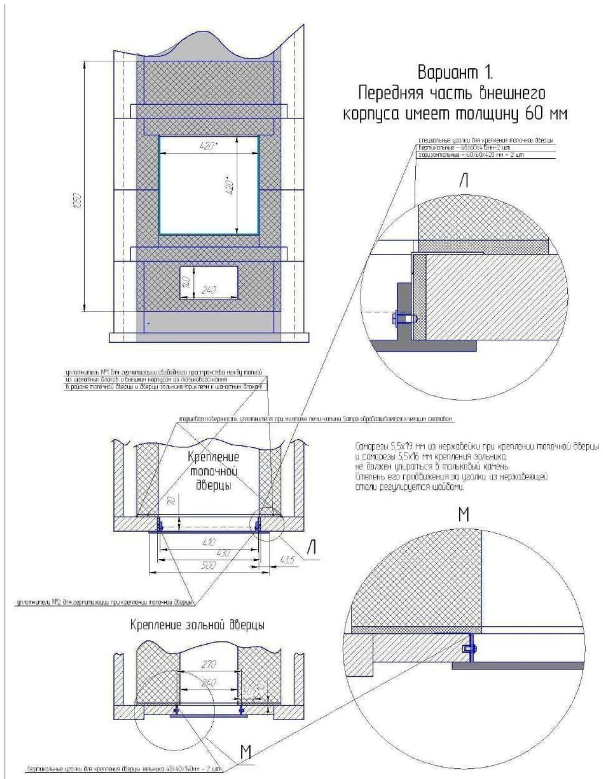
Схема сборки уплотнения топочной и зольной дверцы
