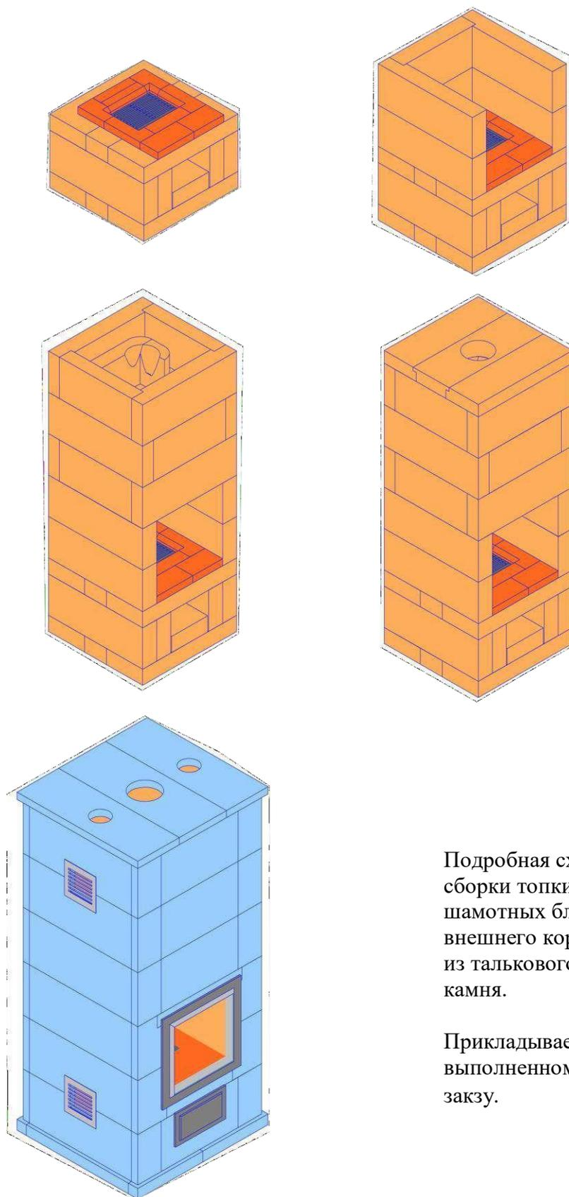
Подробная схема сборки топки из шамотных блоков и внешнего корпуса из талькового камня.
