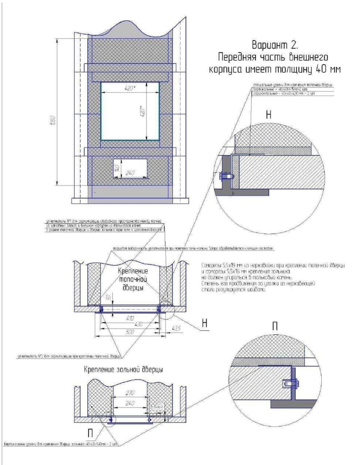
Схема изготовления уплотнения топочной и зольной дверцы
